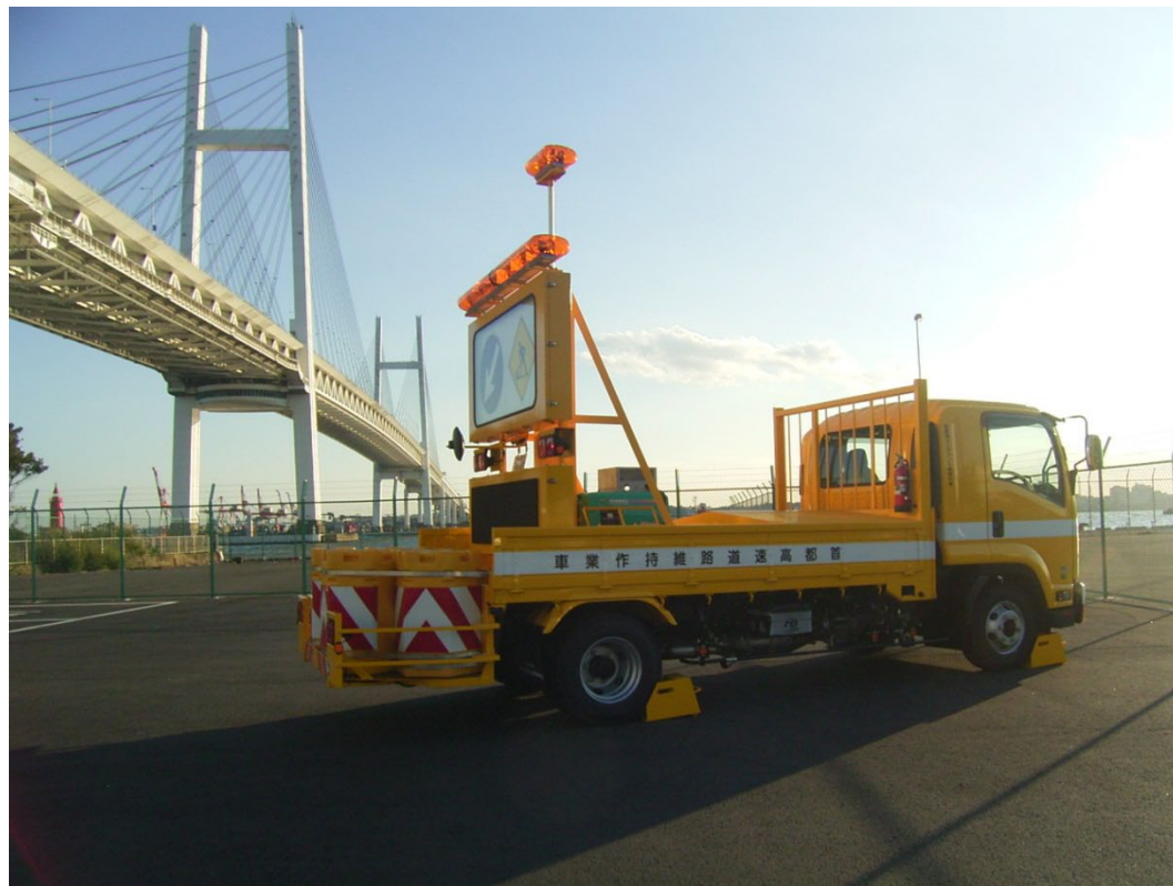
発電機電力で標識装置を稼働 車両ライト及びハザードを点灯
