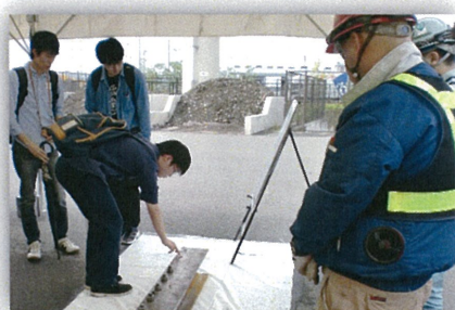
▲ 横河ブリッジさんの精度の 高いストップホールに、学生さ んも興味津々でした。
