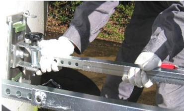
スライド部をずらし、磁石を鋼製面へ取付
