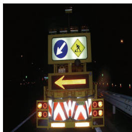
発電機電力で標識装置を稼働 車両ライト及びハザードを点灯
